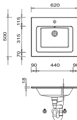
Plans vasque sans consoles de fixation viennent fixé au mur et dans les côtés du meuble avec silicone!
