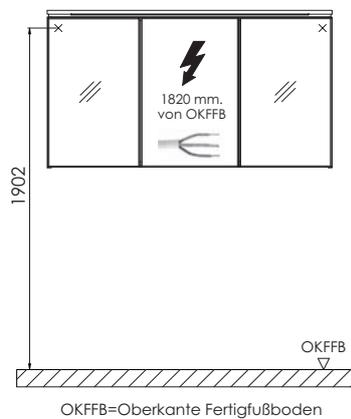
Bei Waschtischanlagen mit Befestigungsschrauben müssen die Maße zum Bohren vor Ort, nach dem Auflegen des Waschtisches auf den Unterschrank, angezeichnet werden. Waschtische ohne Befestigungskonsolen werden mit Silikon an der Wand und auf den Möbelseiten befestigt!
