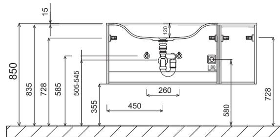
Plans vasque sans consoles de fixation viennent fixé au mur et dans les côtés du meuble avec silicone!
