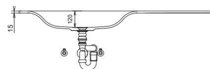
Plans vasque sans consoles de fixation viennent fixé au mur et dans les côtés du meuble avec silicone!
