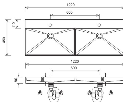
Dans les plans vasque avec vis de fixation les mesures de perçage doivent être signés après avoir posé le plan vasque sur l'élément sous-plan vasque sur place. Les vis de fixation doivent être vissées
