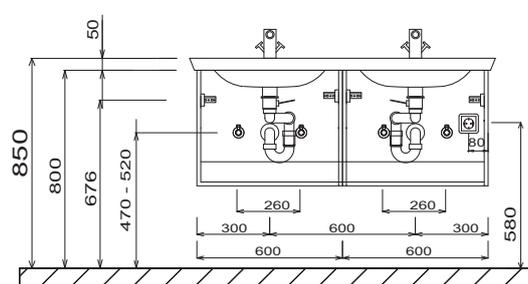
Dans les plans vasque avec vis de fixation les mesures de perçage doivent être signés après avoir posé le plan vasque sur l'élément sous-plan vasque sur place. Les vis de fixation doivent être vissées
