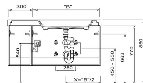
Dans les plans vasque avec vis de fixation les mesures de perçage doivent être signés après avoir posé le plan vasque sur l'élément sous- plan vasque sur place. Les vis de fixation doivent être vissées
