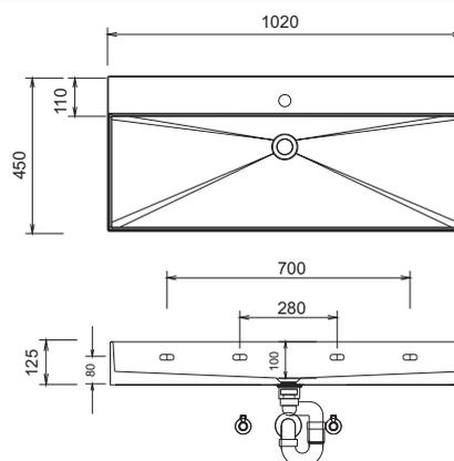
Dans les plans vasque avec vis de fixation les mesures de perçage doivent être signés après avoir posé le plan vasque sur l'élément sous-plan vasque sur place. Les vis de fixation doivent être vissées
