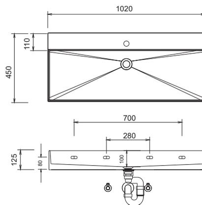
Bei Waschtisanlagen mit Befestigungsschrauben müssen die Maße zum Bohren vor Ort, nach dem Auflegen des Waschtisches auf den Unterschrank, angezeichnet werden. Waschtische ohne Befestigungskonsolen werden mit Silikon an der Wand und auf den Möbelseiten befestigt!
