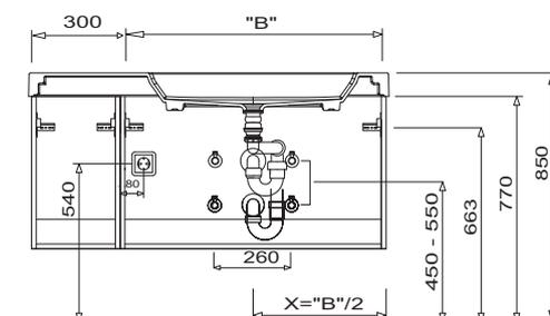
Bei Waschtisanlagen mit Befestigungsschrauben müssen die Maße zum Bohren vor Ort, nach dem Auflegen des Waschtisches auf den Unterschrank, angezeichnet werden.
