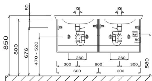
Bei Waschtisanlagen mit Befestigungsschrauben müssen die Maße zum Bohren vor Ort, nach dem Auflegen des Waschtisches auf den Unterschrank, angezeichnet werden.
