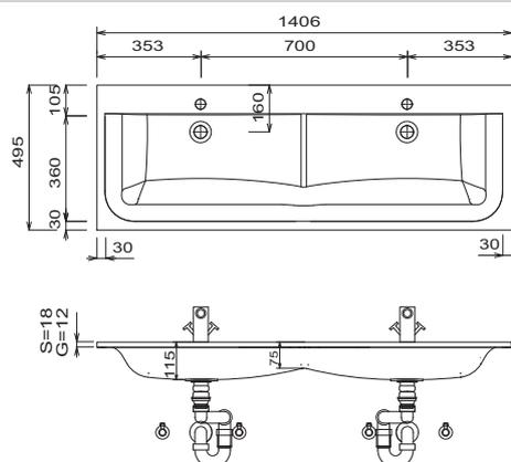
Plans vasque sans consoles de fixation viennent fixé au mur et dans les côtés du meuble avec silicone!
