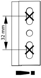
Befestigung der Aufhängingleisten mit 2 Schrauben!
