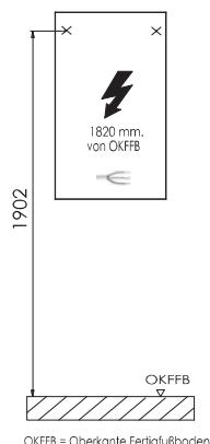
OKFB = Oberkante Fertigfußboden
