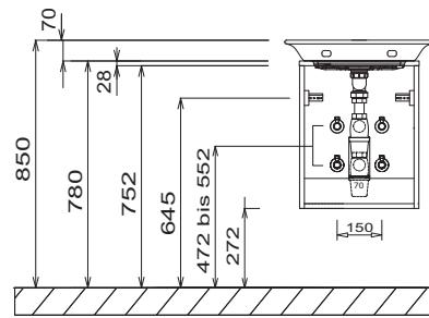
Bei Waschtischanlagen mit Befestigungsschrauben müssen die Maße zum Bohren vor Ort, nach dem Auflegen des Waschtisches auf den Unterschrank, angezeichnet werden.
